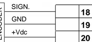
Brancher le câble de SIGNAL de l'encoder au borne 18 du tableau de commande. Brancher le câble de GND de l'encoder au borne 19 du tableau de commande. Brancher le câble de +Vdc de l'encoder au borne 20 du tableau de commande. **ATTENTION: Laisser ouvert si non utilisé.**
