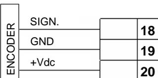
Conectar el cable de SIGNAL del encoder al borne 18 de la regleta de bornes.
