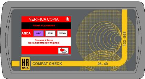
Seleccione la banda a la que pertenece el mando a distancia. Si no conoce la frecuencia de transmisión, déjela en AUTO. Mantenga pulsada la tecla del mando a distancia original para realizar el PRIMER ESCANEOS y siga las instrucciones que se muestran en la pantalla. Si se requiere un SEGUNDO ESCANEOS, repita la operación.
