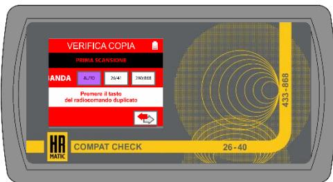
Mantenga presionada la tecla del emisor **Artmatic M2** para realizar el **PRIMER ESCANEOS** y siga las instrucciones que se muestran en la pantalla. Si se requiere un **SEGUNDO ESCANEOS**, repetir la operación.
