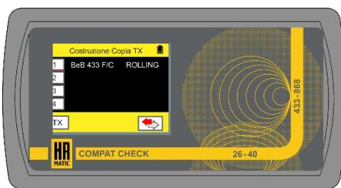
Copie el emisor **Artmatic M2** presionando simultáneamente los botones **1** y **4** hasta que los **LED** correspondientes a los botones (**1/4** y **2/3**) parpadeen en direcciones opuestas, luego suéltelos. Ahora haga clic en **OK** para comenzar a programar.
