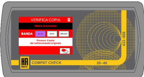
Rimuovere il radiocomando originale e posizionare nell'area di programmazione il radiocomando **Artmatic M2\*** precedentemente duplicato.
