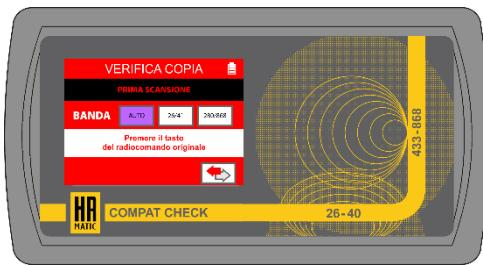
Selezionare la banda a cui appartiene il radiocomando. Nel caso in cui la frequenza di trasmissione non sia nota lasciare su **AUTO**.
