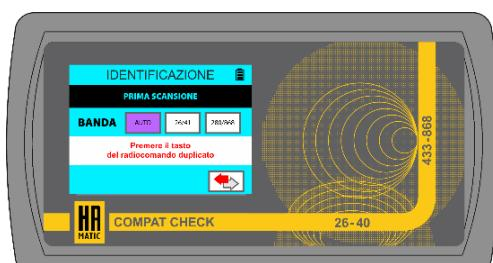
Premere e tenere premuto il tasto del radiocomando duplicato per effettuare la **PRIMA SCANSIONE** e seguire le indicazioni visualizzate nel display. Nel caso in cui sia necessaria una **SECONDA SCANSIONE** ripetere l'operazione. Se l'operazione di duplicazione tra i radiocomandi effettuata precedentemente è andata a buon fine viene visualizzato **OK** per qualche secondo.
