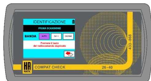
Mantenga pulsada la tecla del emisor duplicado para realizar el **PRIMER ESCANEÓ** y siga las instrucciones que se muestran en la pantalla. Si se requiere un **SEGUNDO ESCANEÓ**, repita la operación. Si la operación de duplicación entre los emisores realizada anteriormente se ha realizado con éxito, se muestra **OK** durante unos segundos.
