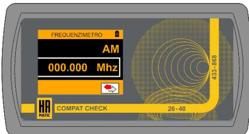
Mantenga presionada la tecla del emisor hasta que el programador detecte la frecuencia, luego suelte la tecla.
