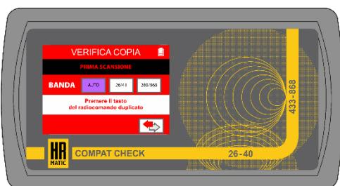
Premere e tenere premuto il tasto del radiocomando **Artmatic M2** per effettuare la **PRIMA SCANSIONE** e seguire le indicazioni visualizzate nel display. Nel caso in cui sia necessaria una **SECONDA SCANSIONE** ripetere l'operazione.
