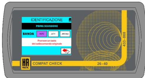
Seleccione la banda a la que pertenece el mando a distancia. Si no conoce la frecuencia de transmisión, déjela en **AUTO**. Mantenga presionado el botón del control remoto para realizar el **PRIMER ESCANEÓ** y siga las instrucciones que se muestran en la pantalla. Si se requiere un **SEGUNDO ESCANEÓ**, repita la operación.
